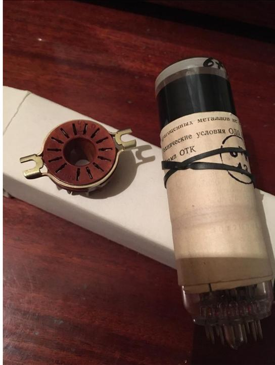
Осциллографическая трубка ЗЛОИ
