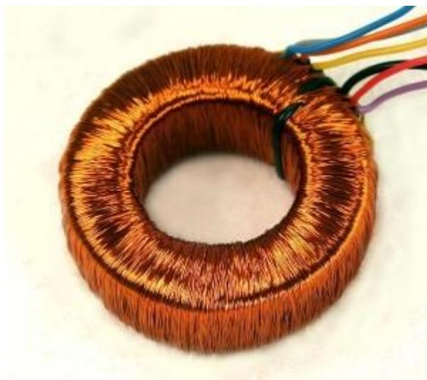
2) Примерно так, только намотка производилась проводом ПЭВ (или ПЭЛ или ПЭТ) - 0.4-0.5 мм (длина провода 130 м для диаметра 0.4 мм) на один оборот
